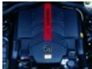
Basis G 500 3-Ventiler; 276 kW (375 PS); 550 Nm bei 3.000 - 4.250 U/min.,
